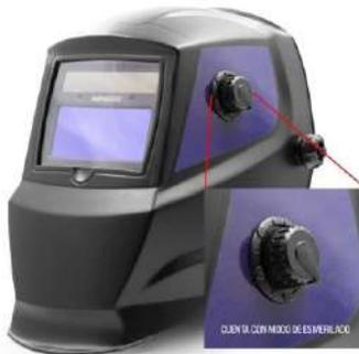
Cuenta con dos sensores independientes para la detección del arco, batería reemplazable tipo CR2032 de 3 volts. Esta careta es ideal para procesos de electrodo revestido / Microalambre / TIG - 10 amp. Su gran respuesta de 1 / 25000 segundos de transparente a obscuro te permite soldar de manera práctica, además cuenta con la capacidad de recargarse solarmente.
